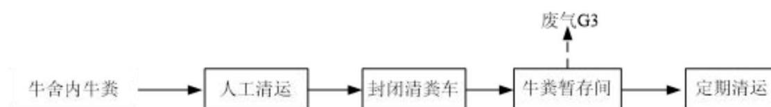
图 2.7-3 牛粪清运工艺及排污节点图
