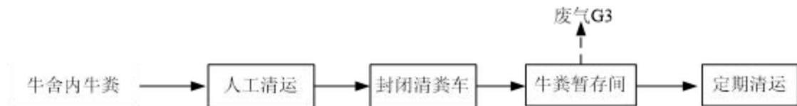
图 3.7-3 牛粪清运工艺及排污节点图
