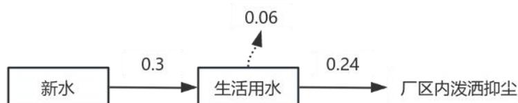
**图 2-1 项目生活水平衡图 单位：m<sup>3</sup>/d**
