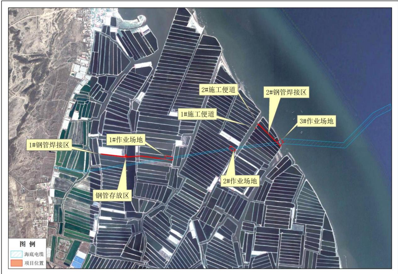
图1.4-1 临时施工场地平面分布图
